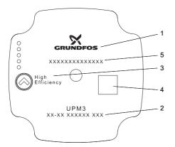
Fig. 5 Nameplate: Grundfos standard
