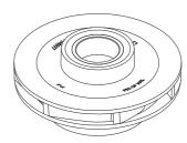
Fig. 45 Impeller
